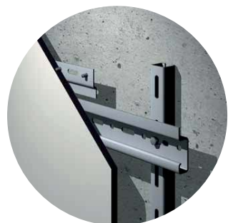
Neviditelné mechanické upevnění
