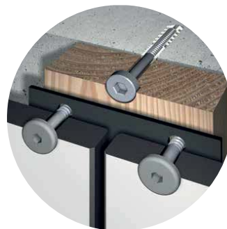
Viditelné mechanické upevnění
