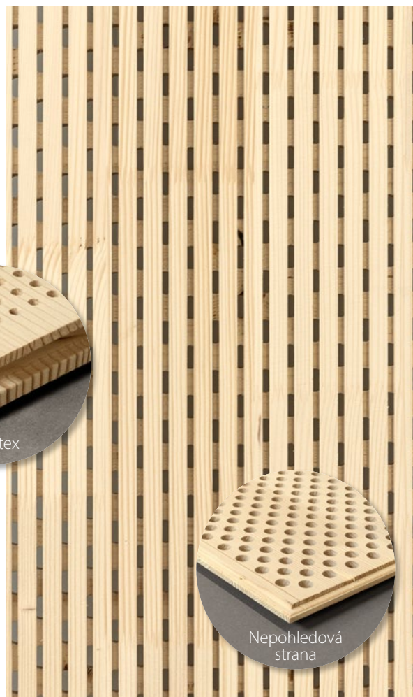
Profil S/L – pohledová strana drážkování 4/12, nepohledová strana vrtání 16/32-32
