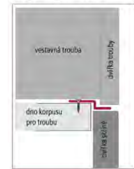
Umístění spodní ochranné lišty MT/spodníS (pohled z boku)
