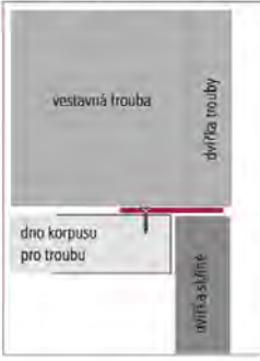
Umístění spodní ochranné lišty MT/spodníB (pohled z boku)
