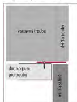
Umístění spodní ochranné lišty MT/spodníB (pohled z boku)
