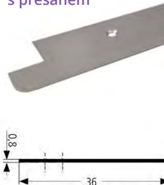
Umístění spodní ochranné lišty MT/spodníB (pohled z boku)
