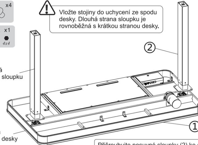
Přišroubujte posuvné sloupky (2) ke stolové desce pomocí šroubů (A) a imbusového klíče (C)
