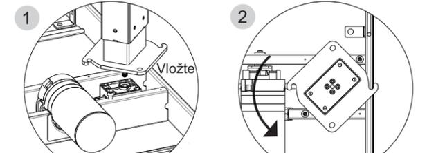
Vložte šestihraničnou hlavu sloupku podél elektroinstalačního žlabu.
