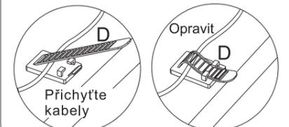
Připojte kabel motoru, napájecí kabel (4) a adaptér. Následně připevněte kabely pomocí kabelového držáku (D)
