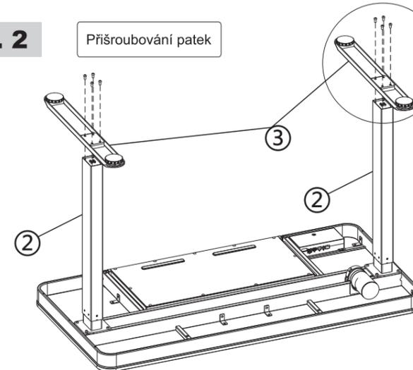
Přišroubujte patky (3) ke stojinám (2) pomocí šroubů (B) a utáhněte imbusovým klíčem (C)
