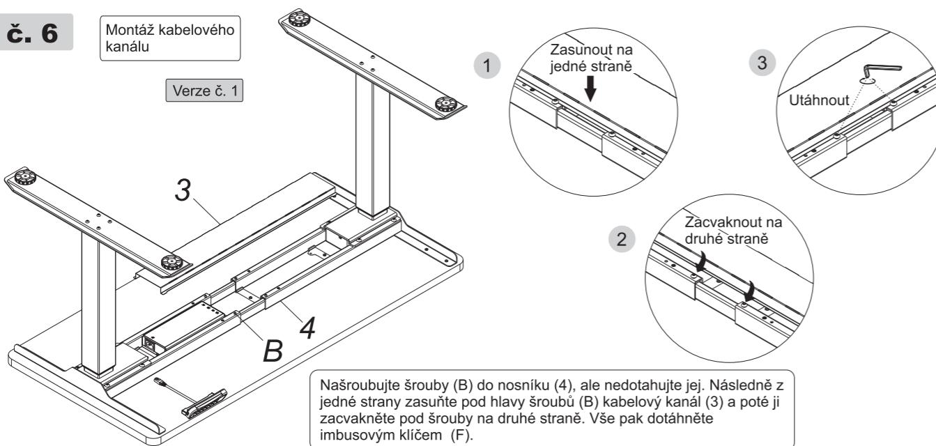
Našroubujte šrouby (B) do nosníku (4), ale nedotahujte jej. Následně z jedné strany zasuňte pod hlavy šroubů (B) kabelový kanál (3) a poté ji zacvakněte pod šrouby na druhé straně. Vše pak dotáhněte imbusovým klíčem (F).
