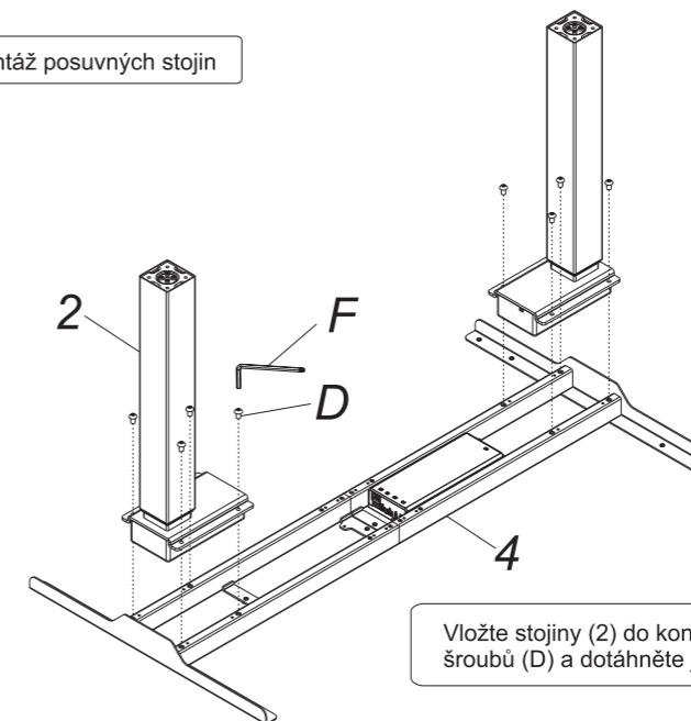
Vložte stojiny (2) do konců nosníku (4). Stojiny přišroubujte pomocí šroubů (D) a dotáhněte je imbusovým klíčem (E).
