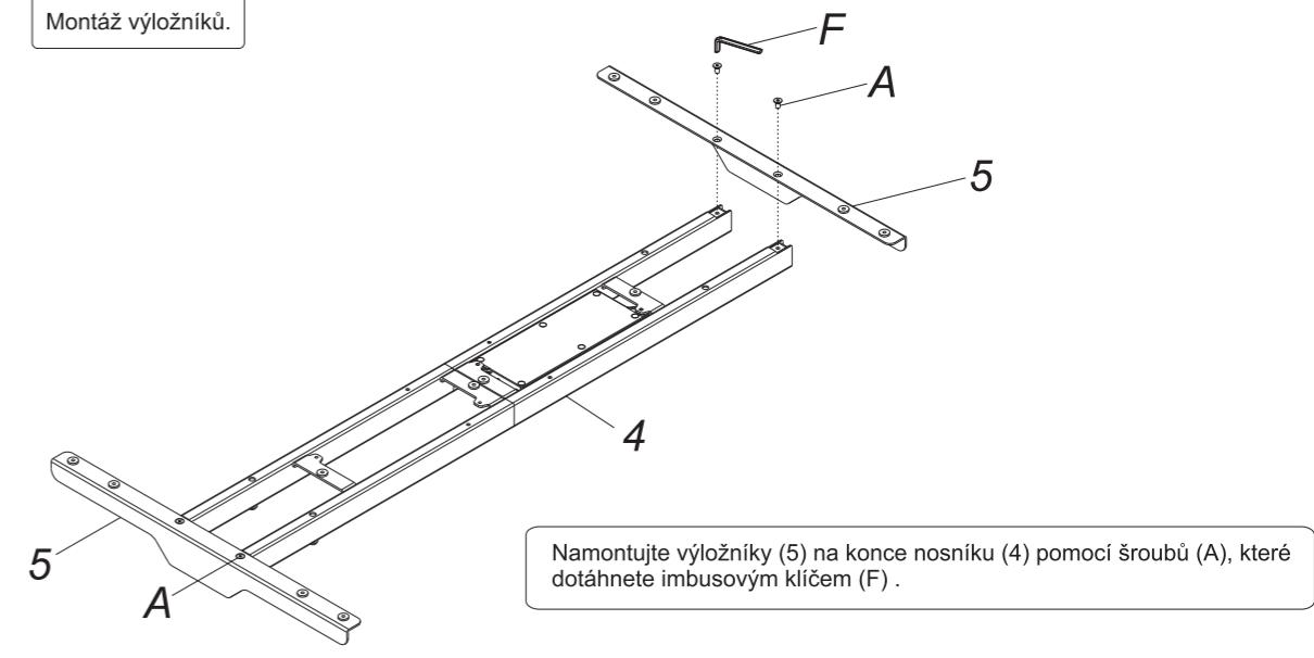
Namontujte výložníky (5) na konec nosníku (4) pomocí šroubů (A), které dotáhněte imbusovým klíčem (F).
