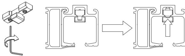
\*Chwytek samodomykacza jest elementem przesuwnym i można go dowolnie przesuwać w szynie. Wymiar jest orientacyjny.
